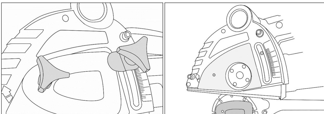
Рис. 2. Снятие винтов
